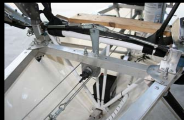
Il semplicissimo collegamento dei cavi teleflex sul rinvio della barra alle spalle del sedile
