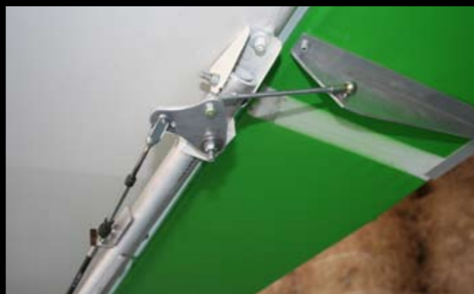
Gli alettoni sono adesso comandati da cavi teleflex completamente esterni
